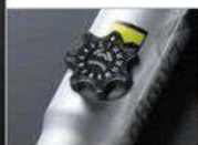
下方旋鈕可調整14段阻尼力(部分車型)
